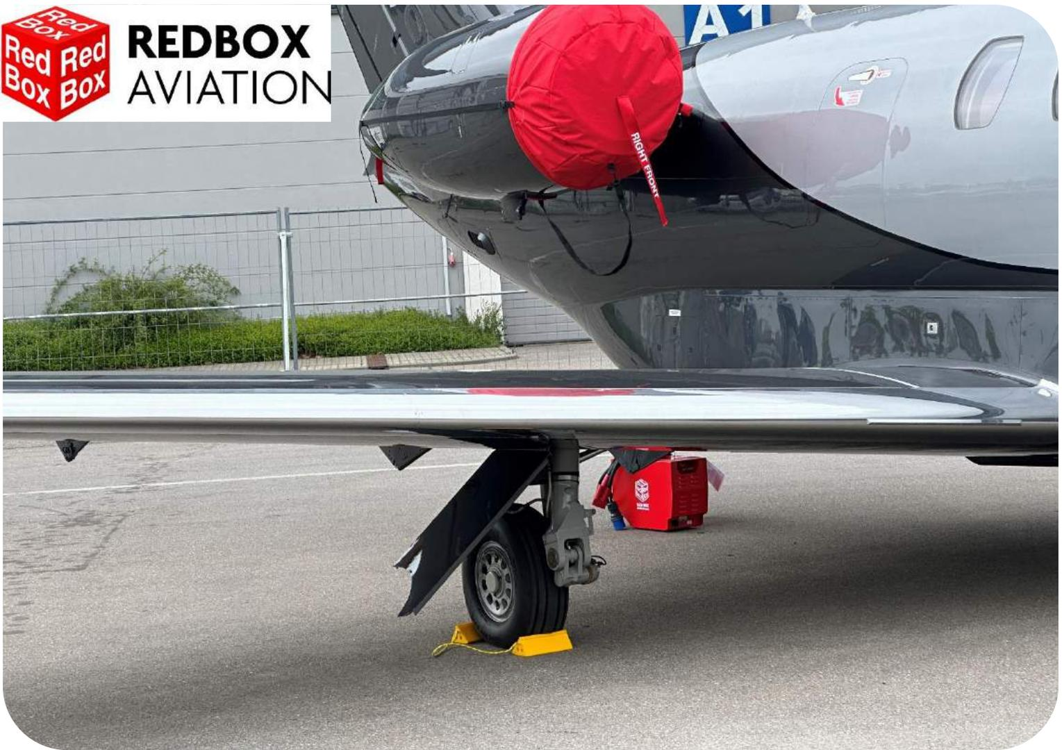
**28Vdc Startgeräte / Bodenstromgeräte**
